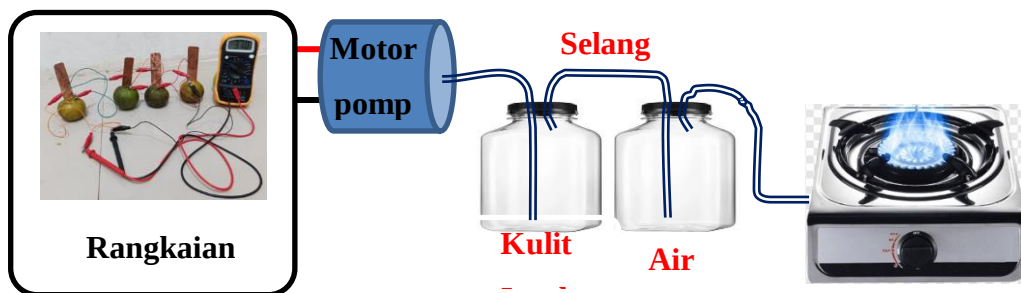
Gambar 6. Rancang bangun kulit jeruk penghasil gas bertenaga baterai buah.
