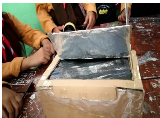
Gambar 7. Proses pembuatan oven tenaga matahari dengan menggunakan cardboard bekas.
